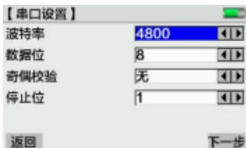
设置好后点击“下一步”进入【串口测量】界面，在本界面下进行串口测量，
